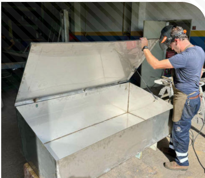
Construção de caixa em Aço Inoxidável para apoio no transporte de ferramentas nas viaturas dos Serviços de Água.
